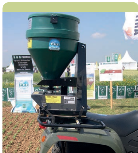
Pour un épandage précis des appâts, De Sangosse recommande l'épandeur Spando équipé d'un système de régulation DPAE avec GPS.
