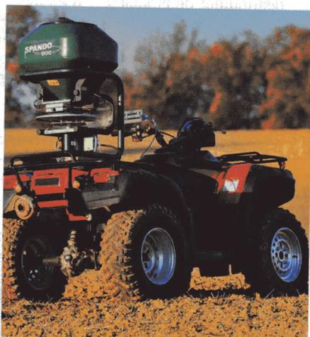
Face aux inconvénients des épandeurs centrifuges monodisques, la solution passe par l'adjonction d'un deuxième disque. Et aussi d'un DPA, ce que propose ce nouvel appareil.
