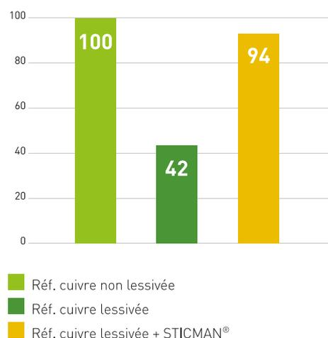
Test de résistance au lessivage
