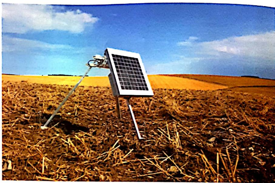
▲ Le capteur Limacapt permet le comptage automatisé des limaces aux champs.
